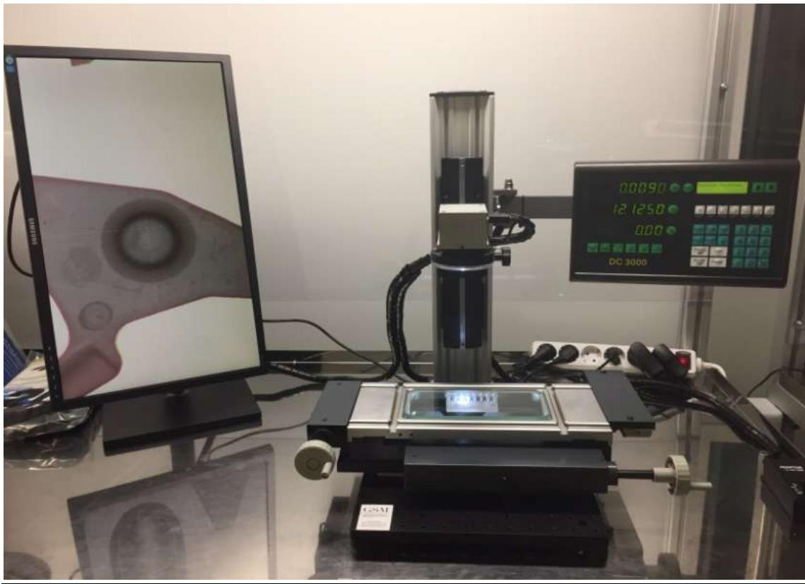
**Máquina de visión 2D, pensada para taller, de uso tipo proyector de perfiles, sencillo rápido y práctico.**
